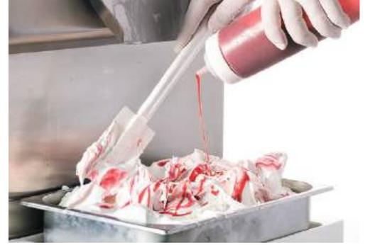
Dank des Wechselrichters kann das **Eis in der Schale marmoriert werden** ohne die Maschinen stoppen oder die Klappe schließen zu müssen: die Rührwerkgeschwindigkeit kann soweit reduziert werden, bis die Ausgabe vollkommen gestoppt wird. Damit wird das Verteilen des Toppings erleichtert. Durch erneutes Steigern der Rührgeschwindigkeit beginnt die Eisausgabe erneut.
