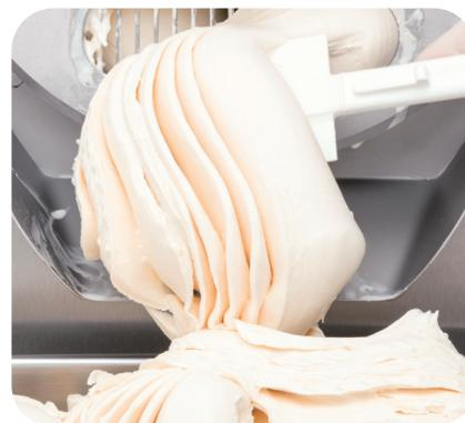
**Estrazione del gelato** - Al termine del ciclo, il gelato viene mantenuto in macchina alla giusta consistenza; l'estrazione è completa e rapida.
