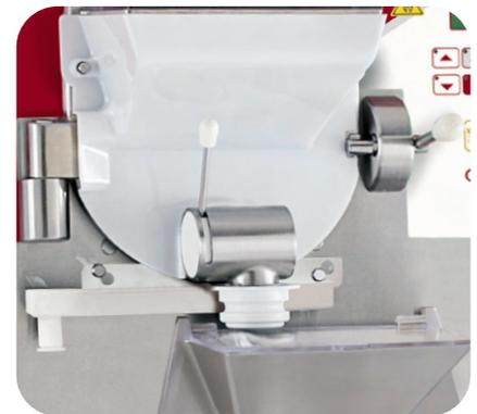
**Passaggio diretto** - La miscela viene trasferita nel cilindro di mantecazione attraverso il rubinetto esterno.
