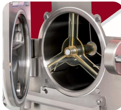
**Pastorizzazione** - Premendo il tasto riscaldamento si avvia il ciclo che può essere regolato fino a 105°C di temperatura. I pulsanti di comando sono di facile interpretazione; un segnale acustico/visivo avvisa quando la temperatura è stata raggiunta.
