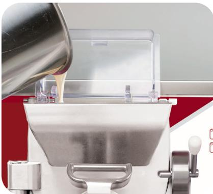
**Miscelatore orizzontale** - Si versano nella tramoggia del cilindro superiore gli ingredienti, affinché siano miscelati. L'elevata velocità di rotazione permette la dispersione degli ingredienti secchi nella miscela.
