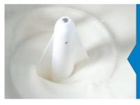
Rührwerk im Behälter. Verhindert die Verkrustung von Produkten während der Konserwierung und verbessert den Wärmeaustausch während der Pasteurisierung.
