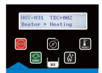
Multifunktions-Reinigungstaste. Möglichkeit, Pumpe und Rührwerk je nach Reinigungsbedarf einzeln oder gemeinsam zu aktivieren oder zu deaktivieren. Eine der Funktionen ist die beheizte Reinigung. Durch Aktivierung des Rührwerks und gleichzeitige Erwärmung der Zylinderoberfläche werden Rückstände von Produktionsfett schnell gelöst.
