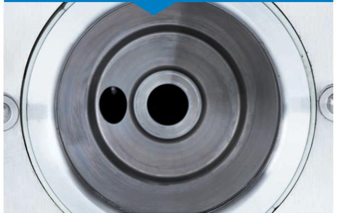
**Rührwerk im Behälter.** Verhindert die Verkrustung von Produkten während der Konservierung und verbessert den Wärmeaustausch während der Pasteurisierung.
